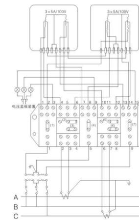
FJ6/PJ2型三相三相三线联合接线盒一只三相有功电度表和一只三相无功电度表,二只流变V/V接线压变联合接线图
