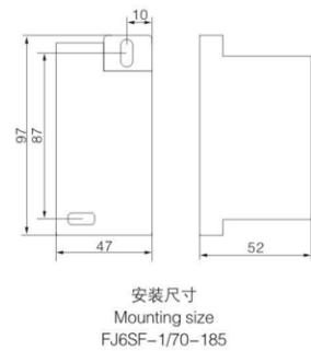
FJ6SF-1/70-185系列多用途封闭式防窃电接线端子(一进多出)
