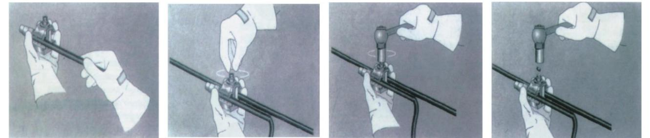
1. 将断面整齐的支线插入分支器盖套
